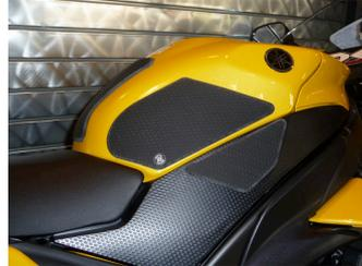
テックスペック グリップスターグリップパッドは車種別に専用設計され 5 種類の素材から目的別に選択する事が可能です。ニーグリップ時の滑りやズレ、車体へのキズの保護にも役立ちます。また、特殊粘着材を使用しているため車両メンテナンス時に張り直しが可能です。
